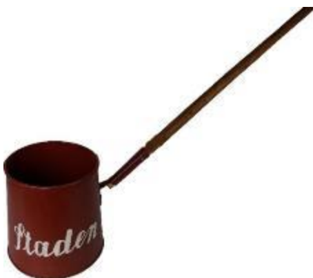
Öshink från Karlstad (nyttillverkat efter original). Dessa användes för att ösa upp vatten från öppna vattentag eller brunnar till en vattentunna. Bilden visar Kristinehamns vattenkörare och vattenösare.
