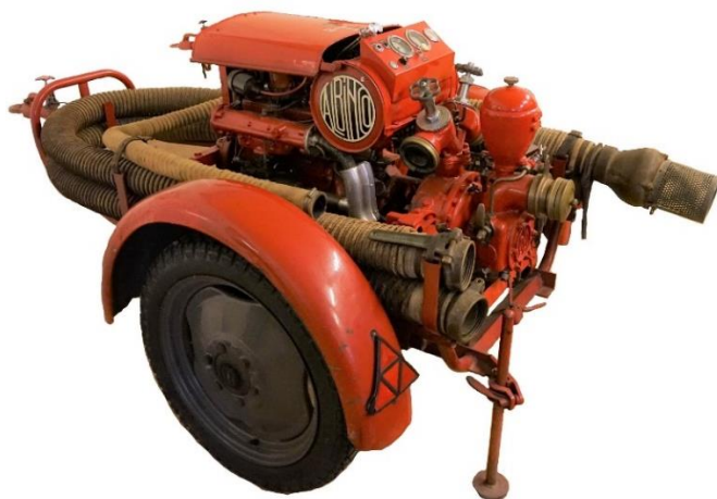
FIG. 4. Den bärbara delen avbröstas snabbt genom att tippas av kärnan sedan ett par klämmor lossats.
