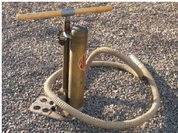
Denna Albinmodell gav ca 35 l/min vilket krävdes av Luftskyddsinspektion. Foto Björn Albinson
