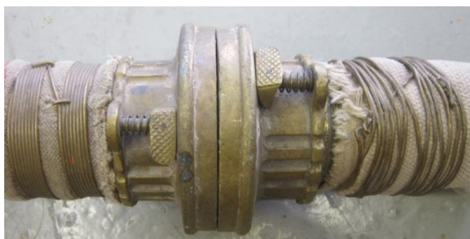
Slangen lindades mot kopplingarna som var av mässing. Foto Björn Albinson
