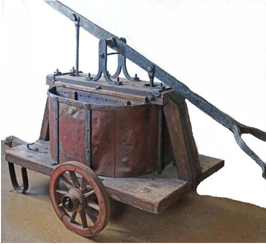
Kopparspruta från Filipstad (1700-tal) och träspruta från Skoghall med unik läderslang och fint smide
