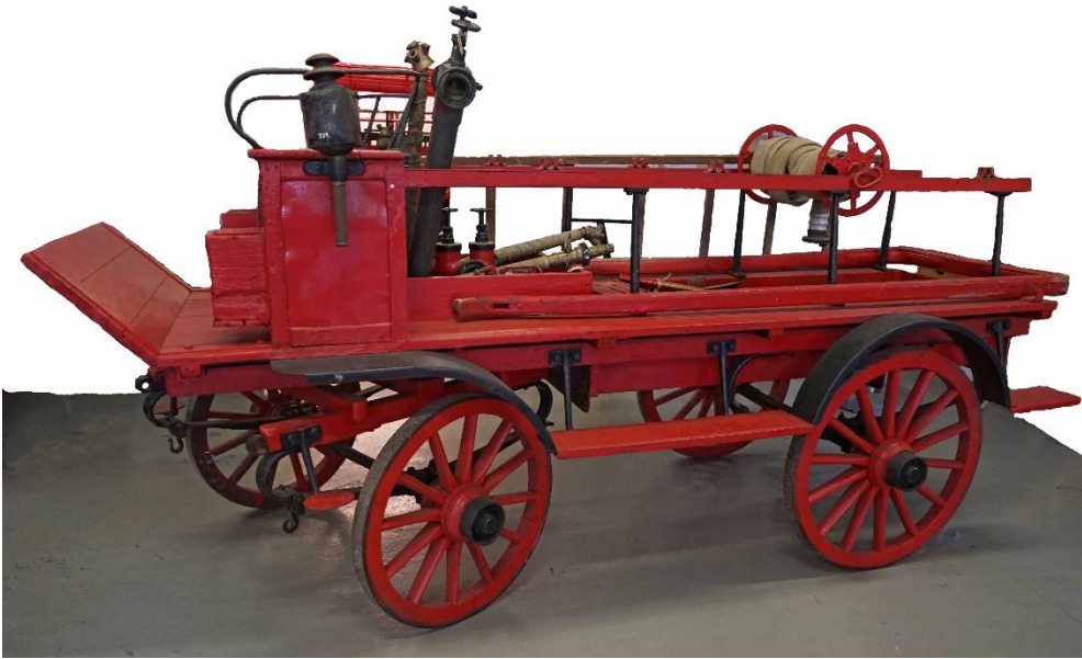
Hästdragen materielkärra från Skoghalls Bruks materialkärra med plats för slang, redskap, armatur, stegar mm
