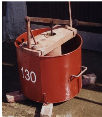
Spruta från gård 130 i centrala Karlstad. Slaglängd 23 cm cylinder 90 mm. Joh. R Holmgrens Sprutfabrik Stockholm. Foto Björn Albinson
