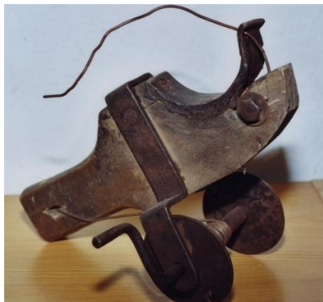
Anordning för att linda fast slang på kopplingen. Foto Björn Albinson
